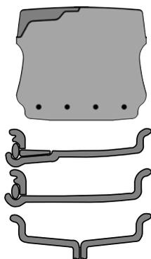
Шины в стандартном исполнении монтируются на разборные колеса из двух половинок и сварные колеса с запорными кольцами.
